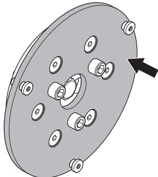
Des douilles de remplacement en silicone sont disponibles et peuvent être remplacées sans mettre la tête de meulage au rebut.
