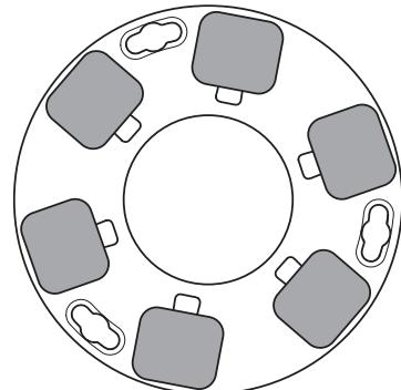
Une modification de la configuration des diamants sur les disques permet à l'opérateur d'altérer considérablement les performances de la machine et donc du produit fini.
