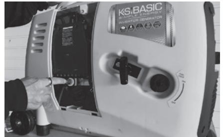
2. Натисніть 5-6 разів на насос для прокачки палива по паливній системі.
