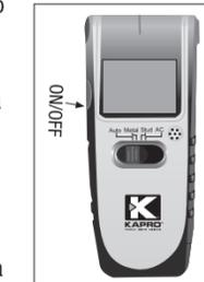
Cuando aparezcan barras completas en el LCD y se emita un tono continuo, usted ha ubicado el extremo del clavo. Marque este punto.
