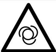
Warnung! Das Gerät ist mit einer automatisierten Anlaufsteuerung ausgestattet. Halten Sie Dritte vom Arbeitsbereich des Gerätes fern!
